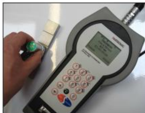
Зонд-толщиномер, применяемый с KATflow 200
