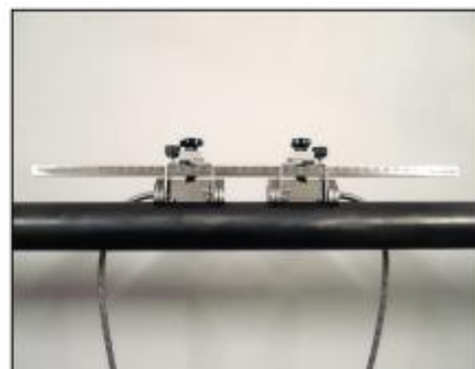
Установочное приспособление, рельсы и магниты
